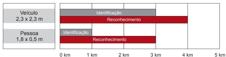
ARGC-750: desempenho de alcance com NFOV e uma visibilidade melhor do que 25 km
